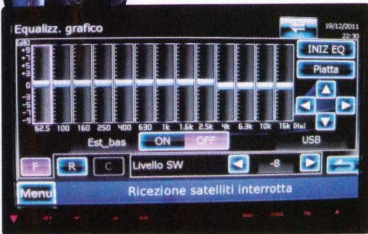
◀ L'equalizzatore agisce su 13 bande differenti. Ottima la possibilità di gestire il fronte anteriore, posteriore e centrale in modo differente in base al diffusore collegato. La funzione Est\_bas compensa i toni bassi ed alti quando il volume è basso.
