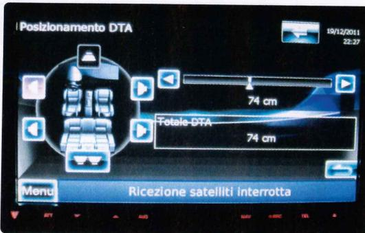
Reparto DTA. Il processore interno è in grado di effettuare ritardi temporali su tutti e sei i canali a disposizione a passi di 2 cm.
